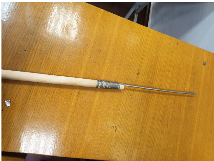
Рисунок № 6 – пример самодельного саперного щупа.
