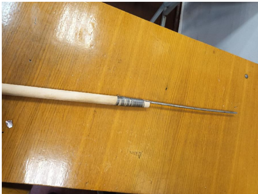
Рисунок № 7 – пример самодельного саперного щупа.
